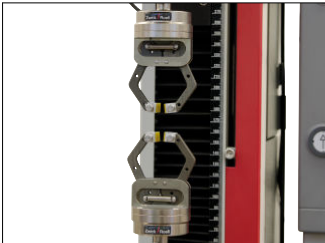
Pneumatik-Probenhalter Typ 8095, Fmax 20 N, mit flexibel anbringbarem Steuerventil
