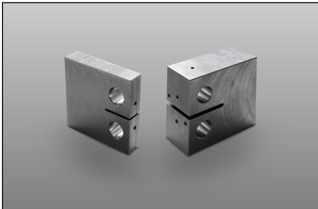
Links: CT Prüfling mit W/B=4 . Gebräuchliche Geometrie für ASTM E647, rechts: CT Prüfling mit W/B=2 . Gebräuchliche Geometrie für ASTM E399
